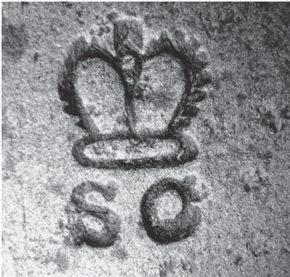
Afb. 7. Op het ijzer van het hek werd dit ingeslagen merkteken aangetroffen dat aangeeft dat het ijzer uit Zweden afkomstig is.
