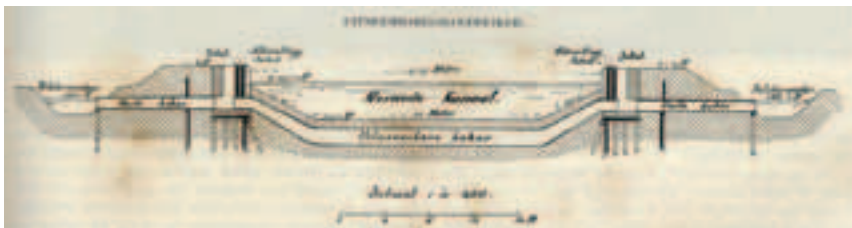
Afb. 26. Doorsnede van een grondduiker, gemetselde hoofden met afsluiters en losse kokers.
